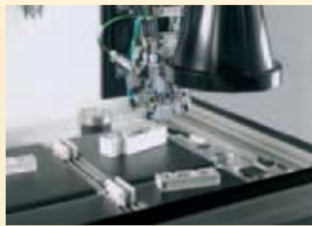
»4 „Sehende“ Misch- und Dosieranlagen vereinbaren wirtschaftliche vollautomatische Verarbeitungsprozesse inkl. einer präzisen Teilezuführung mit häufigen Materialwechseln
