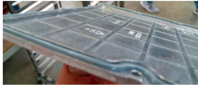
Beispiel einer in Form einer Dosierraupe aufgebracht EMV-Dichtung – alles ist sehr gleichmäßig: keine Stoßstelle ist erkennbar, da der Ein- und Auslauf der Raupe dort überlappen und die Mengen entsprechend angepasst sind
